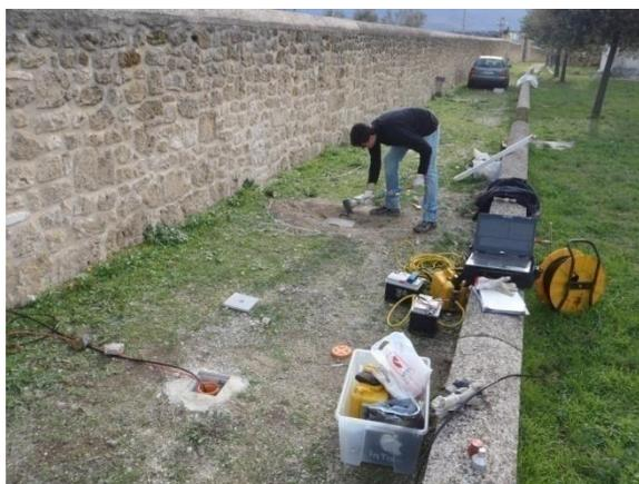
**Figura 5.2.** Generazione di onde P tramite colpo vibrato in verticale su piastra metallica.
