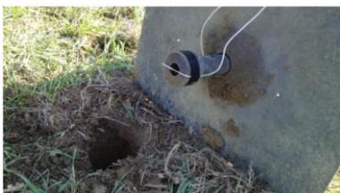
**Figura 4.2.** *Trigger ad apertura di circuito nel caso di cannoncino sismico*
