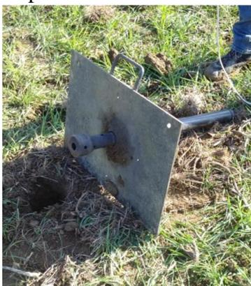
**Figura 4.1.** *Sorgente sismica di tipo a cannoncino MINIBANG*
