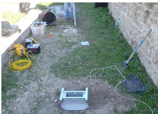
**Figura 5.1** Sorgente a impatto per la generazione di onde SH.
